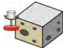
Superficie laterale dopo la foratura
